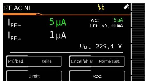
Prüfsequenz – Prüfergebnis (IEC 62368 / EN 62368 / VDE 0868-1)
